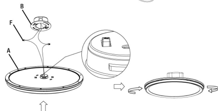
**8a** Fixez la lampe à la plaque de montage en insérant la lampe dans la plaque de montage et tournant la lampe pour l'ancrer.
