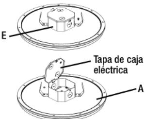
**6b** Use los 2 tornillos de montaje para asegurar la caja de conexiones con clips (no incluidos) a la caja de la lámpara.
