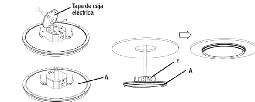
**8b** Pase los cables a través del agujero ciego en la tapa de la caja de conexiones.
