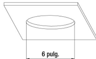
**5b** Encuentre la ubicación de montaje deseada y taladre un orificio de 6 pulg. lo suficientemente grande como para insertar la caja de la lámpara en la ubicación de montaje.
