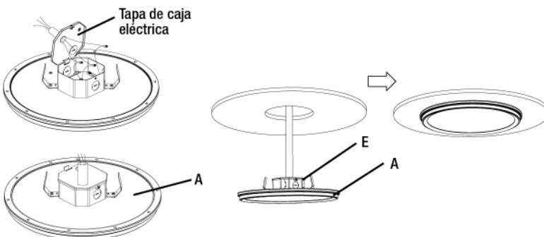
**8b** Pase los cables a través del agujero ciego en la tapa de la caja de conexiones.
