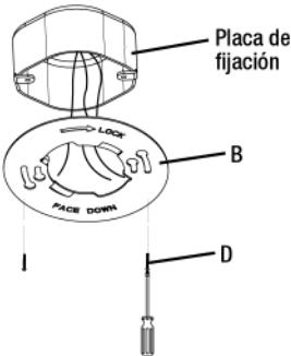
**5a** Fije la placa de montaje a la caja de conexiones.
