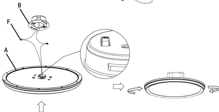
**8a** Fije la lámpara a la placa de montaje insertando la lámpara en la placa de montaje y girando la lámpara hasta que esté segura.
