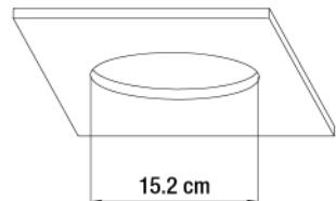
**5b** Établissez l'endroit de montage désiré et percez un trou de 15.2 cm (6 po) assez grand pour introduire le boîtier de la lampe à l'endroit du montage.
