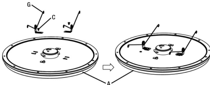
**6c** Utilisez les vis pour fixer les ressorts de torsion (non inclus) à la lampe.
