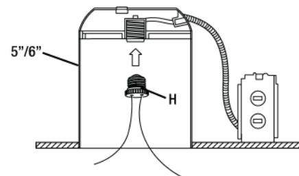
**7c** Vissez l'adaptateur à douille moyenne (E26) dans la douille à l'intérieur du coffret encastré.
