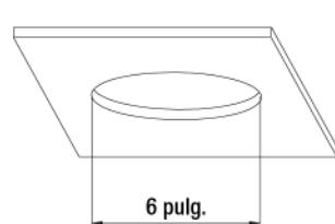
**5b** Encuentre la ubicación de montaje deseada y taladre un orificio de 6 pulg. lo suficientemente grande como para insertar la caja de la lámpara en la ubicación de montaje.
