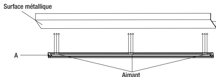
**1b** La lampe est dotée de (3) aimants puissants pour l'installation sur les surfaces métalliques sans utiliser de vis.
