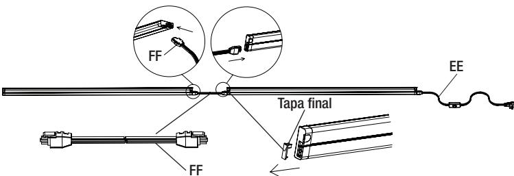
Retire la tapa final y conecte los cables de enlace entre los dos accesorios como se ilustra.
