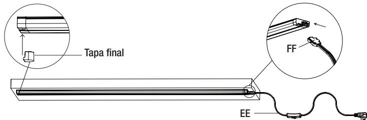
**3a** Conecte el cable con enchufe a la lámpara y conéctelo a la toma de pared correspondiente. Encienda la lámpara con el interruptor de palanca.
