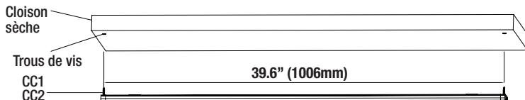
**2a** Percez des trous pilotes pour les vis ou les ancrages pour cloison sèche (selon le besoin). La distance centre à centre entre les trous de montage est de 1 006 mm (39.6 po). Installez la lampe puis remettez les couvercles de trous de vis. (Il en revient à l'installateur d'utiliser les vis et/ou les ancrages appropriés en fonction de la surface de montage.)
