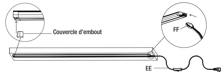
**3a** Connectez le cordon avec fiche à la lampe puis branchez la fiche dans la prise appropriée. Actionnez l'interrupteur pour allumer la lampe.
