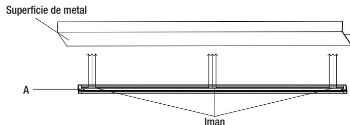
**1b** La lámpara incluye (3) imanes de alta resistencia adecuados para su instalación en superficies metálicas compatibles para una fácil instalación sin tornillos.
