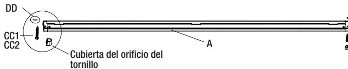
**1a** Retire la cubierta de los orificios de tornillos, preinstale los tornillos (CC1 o CC2) a través de los orificios de tornillos y coloque las juntas tóricas cautivas.
