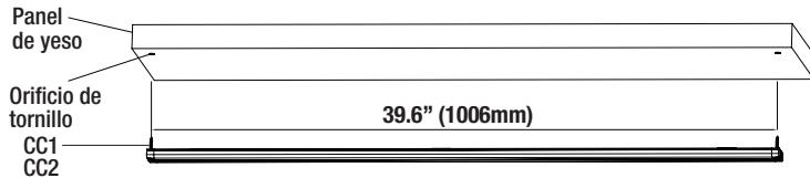
**2a** Taladre orificios piloto para tornillos directos o anclajes para paneles de yeso (según sea necesario). La distancia entre centros de los dos orificios de montaje es (39,6 pulg. o 1006 mm). Monte la lámpara y vuelva a instalar las cubiertas de acceso a los orificios de los tornillos.
