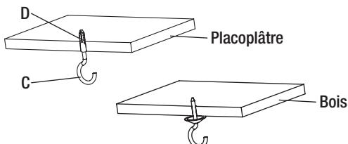
**3** **Placoplâtre :** Percez deux trous de 6 mm dans le plafond. Posez les ancrages pour placoplâtre et les crochets filetés dans chaque trou percé.
