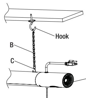
**4** Fije a la lámpara los ganchos S que se encuentran en la parte inferior de las cadenas de montaje. Use unos alicates para cerrar los ganchos en S y asegúrese de que el dispositivo esté seguro.
