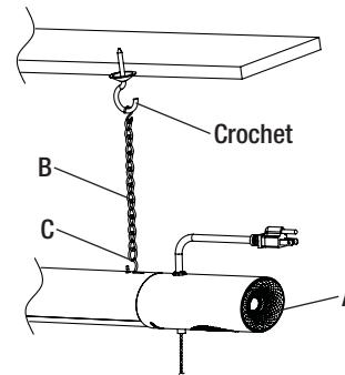
**4** Accrochez à la lampe les crochets en S qui se trouvent au bout des chaînes de montage. Fermez les crochets en S avec des pinces et assurez-vous que la lampe est bien retenue.
