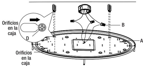
**5** Conecte los cables vivo y neutro (negro y blanco) de la caja de conexiones a los cables del mismo color del cuerpo de la lámpara. Conecte el cable de conexión a tierra de la caja de conexiones al cable verde del cuerpo de la lámpara. Cubra las conexiones de cables con los conectores de cables.
