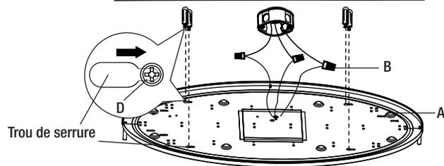
**5** Connectez les fils chauds et neutres (noir et blanc) du J-box aux fils de même couleur de la base du luminaire. Connectez le fil de mise à la terre du J-box au fil vert de la base du luminaire. Couvrez les connexions des fils à l'aide des connecteurs de fils. Assurez-vous de bien les fixer.
