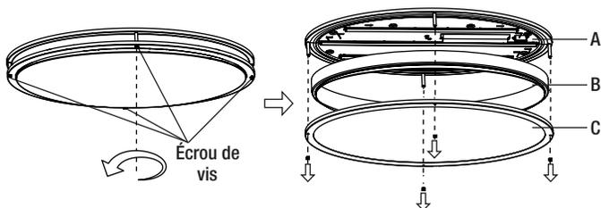
**1** Tournez dans le sens inverse des aiguilles d'une montre pour retirer l'écrou de vis sur l'abat-jour du diffuseur, puis retirez le cadre extérieur et l'abat-jour du diffuseur et mettez-les dans un endroit sûr.
