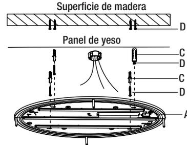
**2** Con la ayuda de otra persona, sostenga temporalmente el cuerpo de la lámpara hasta el techo para determinar la mejor posición de montaje, marque cuatro ubicaciones de orificios para el montaje.
