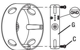
**5** Utilisez 2 vis de montage courtes pour fixer le support à la boîte électrique. Assurez-vous que le texte « GND » soit face vers l'extérieur.
