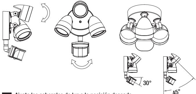
**11** Ajuste los cabezales de luz a la posición deseada.
