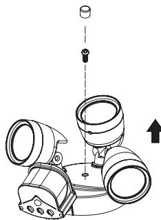
**16 Mantenimiento - Sustitución de la fotocélula.**
