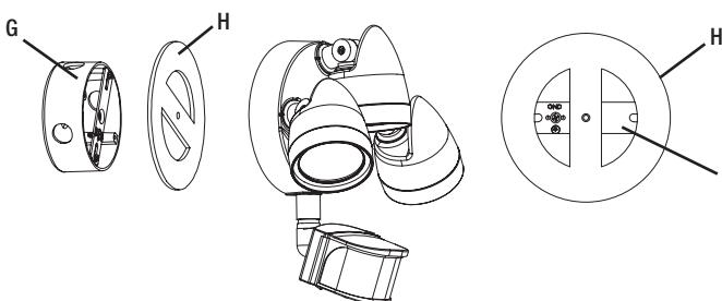
**6** Placez le joint en mousse sur la boîte électrique. Passez les fils de la boîte électrique à travers l'ouverture dans le joint en mousse.
