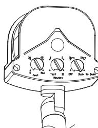
**12** Tester la photocellule détectrice de mouvement :
