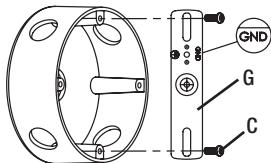
**5** Utilice 2 tornillos de montaje cortos para fijar el soporte de montaje a la caja eléctrica.
