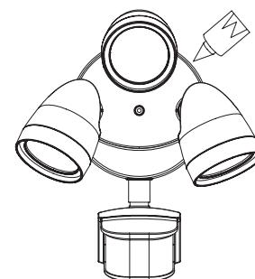
**8** Utilisez la vis de montage longue pour fixer la lampe au support.
