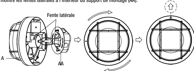
**2** Faites passer les fils chauds et neutres (noir et blanc) de la boîte de sortie électrique à travers le trou central du support de montage (AA). Alignez le support de montage (AA) à l'aide des vis de montage (BB) et serrez fermement au boîtier électrique.
