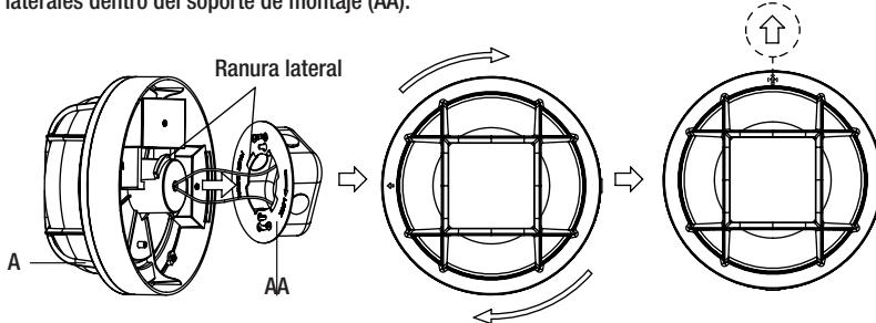
**2** Pase los cables de corriente y neutro (blanco y negro) de la caja de salida eléctrica a través del orificio central del soporte de montaje (AA). Alinee el soporte de montaje (AA) con los tornillos de montaje (BB) y apriete firmemente a la caja eléctrica.
