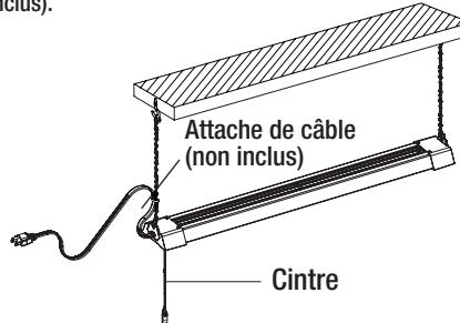
3. Accrochez la lampe d'atelier (A) en plaçant une chaîne (AA) sur chaque crochet (CC) installé au plafond. Ajustez les chaînes pour niveler la lumière. Le luminaire doit être suspendu à au moins 3 in. du plafond.
