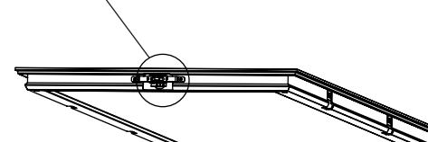
7. Haga que el cable (C) de seguridad de la la base de la lámpara (A) se enganche en el marco externo (B), fije el marco (B) asegúrese de que la dirección del conmutador CCT en la base de la lámpara sea consistente con el marco externo. Complete la instalación.
