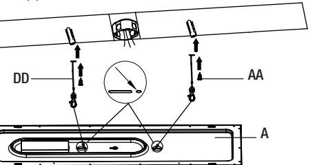
4. Conecte los cables vivo y neutro (blanco y negro) de la caja de conexiones a los cables del mismo color de la base del dispositivo (A). Conecte el cable verde de la caja de conexiones al cable de conexión a tierra de la base del dispositivo (A). Cubra las conexiones de cables con los conectores de cables (BB). Asegúrate de sujetarlos bien. Asegúrate de que estén bien sujetos.
