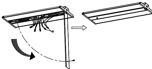
**5b** Fixez les plaques de couverture du support de montage sur les côtés du support de montage.
