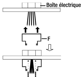
**9a** Insérez les fils dans la boîte du transformateur et remettez le couvercle du transformateur.
