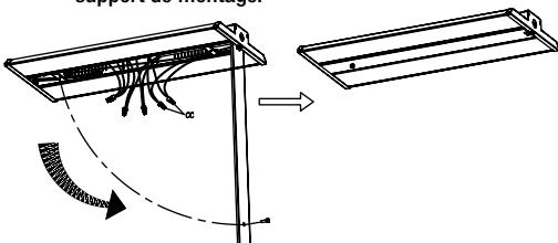
**7c** Effectuez les connexions électriques. Voir les points 8a et 9a du montage en suspension.
