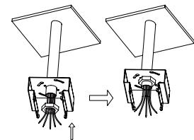
**5c** Passez les fils de la tige à travers le support de montage et utilisez un écrou pour fixer le support de montage à la tige.
