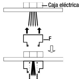
**4b** Pase los cables desde la caja eléctrica a través del soporte de montaje. Use los tornillos de la caja eléctrica para asegurar el soporte de montaje a la caja eléctrica.
