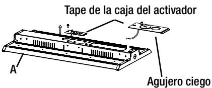
**3b** Retire la tapa de la caja del activador de la caja de la lámpara.
