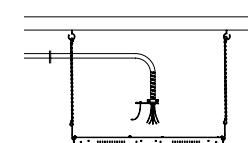
**7a** Posez des crochets (non inclus) dans le plafond et accrochez-y les chaînes métalliques. La lampe doit être suspendue à une distance de 76 cm du plafond.
