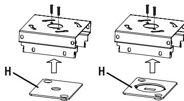
**4c** Au besoin, utilisez des vis pour fixer la plaque de tige 1/2 po ou la plaque de tige filetée 7 mm au support de montage.
