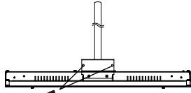
**6c** Placez le boîtier de la lampe contre le support de montage et fixez-le avec 2 vis de chaque côté.
