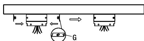
**5b** Fije las placas de cubierta del soporte de montaje a los lados del soporte de montaje.
