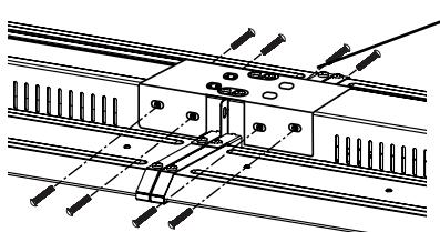
**1** Pour un montage en tandem, placez les extrémités des luminaires l'une contre l'autre et alignez les trous de vis du support avec ceux des lampes et posez les 8 vis.
