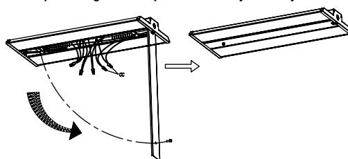
**7b** Realice las conexiones eléctricas. Vea los pasos 8a y 9a en la sección Instalación suspendida.
