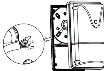
**7** Remplacez le couvercle par les 4 vis, remplissez les trous avec des bouchons en caoutchouc.
