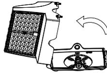
**3** Installez le support du pilote de led d'urgence (EM) sur le luminaire.
