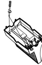
**4** Installez le pilote EM et la batterie sur le support.
