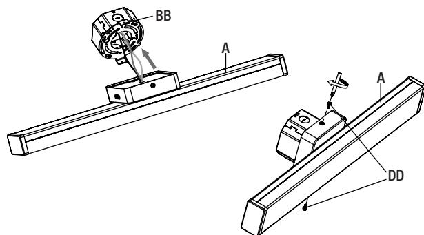
**2** Conecte los cables vivo y neutro (blanco y negro) de la caja de conexiones a los cables del mismo color del cuerpo de la lámpara (A). Conecte el cable de conexión a tierra de la caja de conexiones al cable verde del cuerpo de la lámpara (A). Cubra las conexiones de cables con los conectores de cables (AA). Cubra los conectores de cables (AA) con cinta aislante para una conexión más segura, luego empuje los cables hacia atrás en la caja de conexiones.
