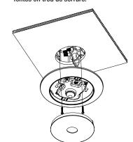
Remplacez l'objectif et tournez-le dans le sens des aiguilles d'une montre pour le verrouiller.
