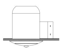
9a Calfeutrez le contour de la surface de montage avec du mastic silicone.
