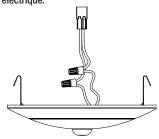
7a Vissez l'adaptateur de base E26 (non inclus) dans la douille du boîtier encastré et faites simplement glisser la garniture et les clips de friction métalliques dans le boîtier.
