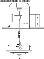
Placez soigneusement les fils dans le luminaire et poussez le luminaire dans le boîtier jusqu'à ce qu'il affleure le plafond.
