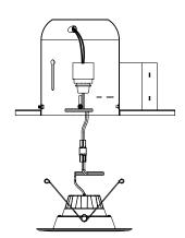
Insérer les deux capuchons, celui de l'adaptateur de douille dans la trousse de modernisation.
