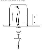
Couper l'alimentation du luminaire. Visser l'adaptateur de douille dans la douille.
