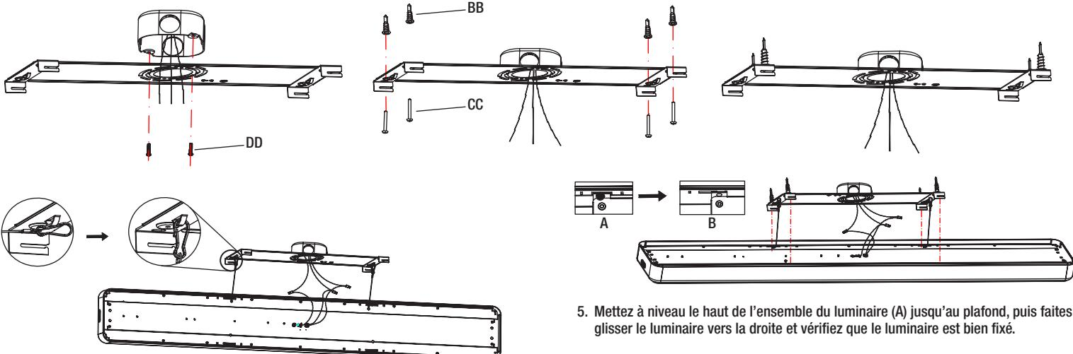
3. Accrochez les deux trous sur le côté gauche du luminaire (A) aux deux crochets situés à l'avant du support de montage (B) en même temps.
