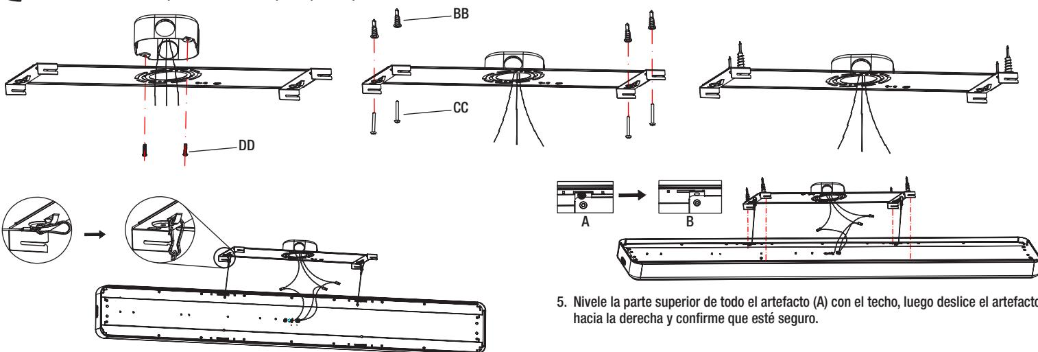
3. Cuelgue los dos orificios del lado izquierdo del accesorio (A) en los dos ganchos del extremo delantero del soporte de montaje (B) al mismo tiempo.
