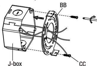
**2** Connectez les fils chaud et neutre (noir et blanc) de la boîte J aux fils de même couleur du corps du luminaire (A). Enroulez le fil de terre du boîtier électrique autour de la vis de terre du support de montage (BB), puis connectez-le au fil vert du corps du luminaire (A). Couvrez les connexions de fils à l'aide des connecteurs de fils (AA). Couvrez les connecteurs de fils (AA) avec du ruban électrique pour une connexion plus sûre, puis remplacez les fils à l'intérieur de la boîte J.
