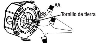
**3** Coloque el agujero de tornillo del cuerpo de la lámpara (A) boca arriba, luego coloque el cuerpo de la lámpara (A) en el soporte (BB), asegurándose de que esté cerca de la pared. Atornille el cuerpo de la lámpara (A) al soporte (BB) usando el tornillo de montaje (DD).
