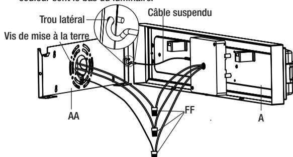
**3** Insérez les languettes sur le dessus de la plaque de montage (AA) dans les trous de montage au bas du corps du luminaire (A). Placez le corps du luminaire (A) contre la plaque de montage (AA), de manière à ce que les trous de vis au bas du corps du luminaire (A) et de la plaque de montage (AA) soient alignés. Vissez les vis de la plaque de montage (BB) dans les trous situés au bas du corps du luminaire (A) pour le fixer à la plaque de montage (AA).
